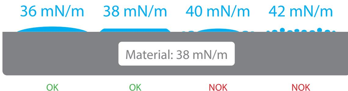
Abbildung 1: Vergrößerte schematische Darstellung des Verhaltens von Prüftinten unterschiedlicher Oberflächenspannungswerte auf einem Substrat im Querschnitt.
